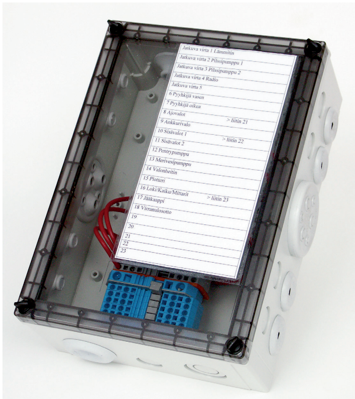
Isompi haaroituskotelo, jonka kannessa on sulakkeiden ja riviliitimien luettelo vianetsintää helpottamaan.
